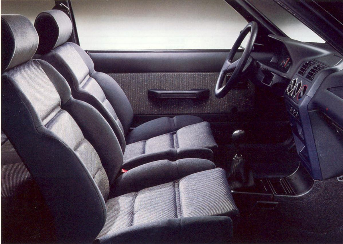
Sièges avant type "baquet" garnis de velours, à dossier inclinable et appui-tête réglable
