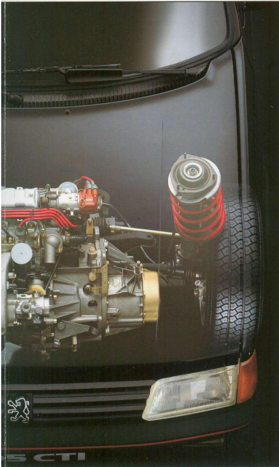
Doch damit alleine sind die technischen Trümpfe der beiden Modelle noch nicht ausgereizt. Beide verfügen über ein aufwendig konstruiertes Fahrwerk mit Einzerradaufhängung, Federbeinen vorn, Drehstabfedern hinten und doppelt wirkenden hydraulischen Teleskopstoßdämpfern vorn und hinten. Dazu sind beide Modelle mit einer Bremsanlage ausgerüstet, die auf das hohe Leistungsniveau abgestimmt ist. Das sportlich abgestufte Getriebe zeichnet sich durch einen „kurzen“ 5. Gang aus.
